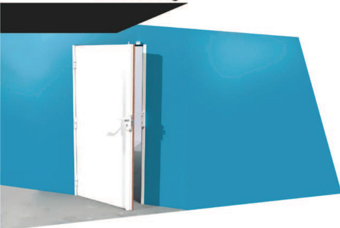
**Blindage pivotant** sur mesure laqué blanc 9010 ou marron Bronze hauteur 2200 mm maximum avec 3 paumelles Maroc 140mm à roulement à billes soudées et trous de fixations percés fraisés en feuillure ( vantail 20/10ème et cadre 25/10ème )
